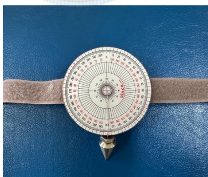
รูปที่ 2 ภาพแสดง โคนิโอมิเตอร์อาศัยแรงโน้มถ่วงแบบดัดแปลง
