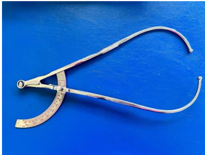
ภาพที่ 8 เครื่องวัดการขยายตัวของทรวงอก (Chest depth caliper)
