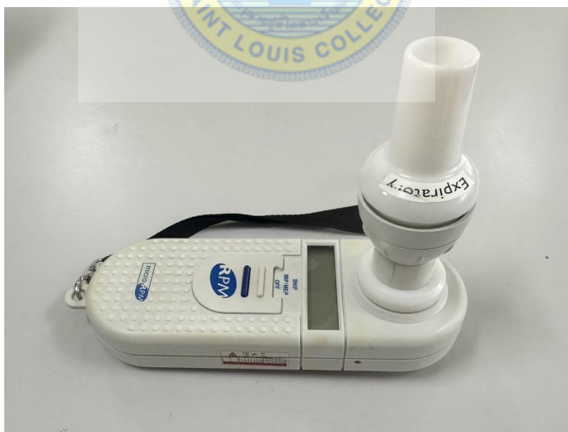
ภาพที่ 7 เครื่องมือวัดความแข็งแรงของกล้ามเนื้อหายใจ ยี่ห้อ micro RPM
